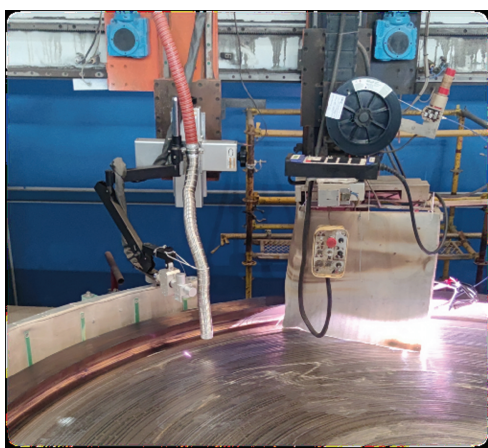
图 7 激光清洗技术在管板堆焊中的应用展示
