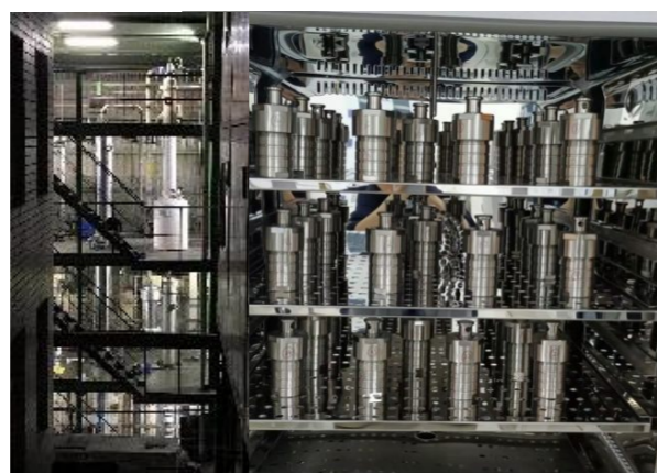
化学吸收法碳捕集200立方米/小时中试验台(左)及防腐试验(右)
