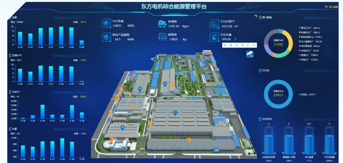
东方电机依托自主研发的综合能源规划软件，深入分析厂区用能特点与资源禀赋，构建出包含内燃机冷热电联供、储能、光伏、地源热泵、空压站、雨水回收、充电桩等在内的一套综合能源系统，为园区能源精细化管理提供了重要支撑。
