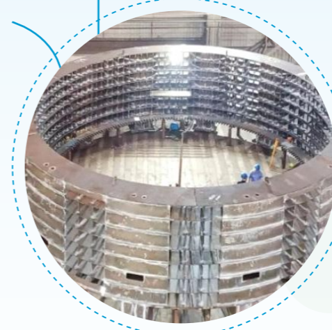
世界首台500兆瓦冲击式水电机组定子支座
